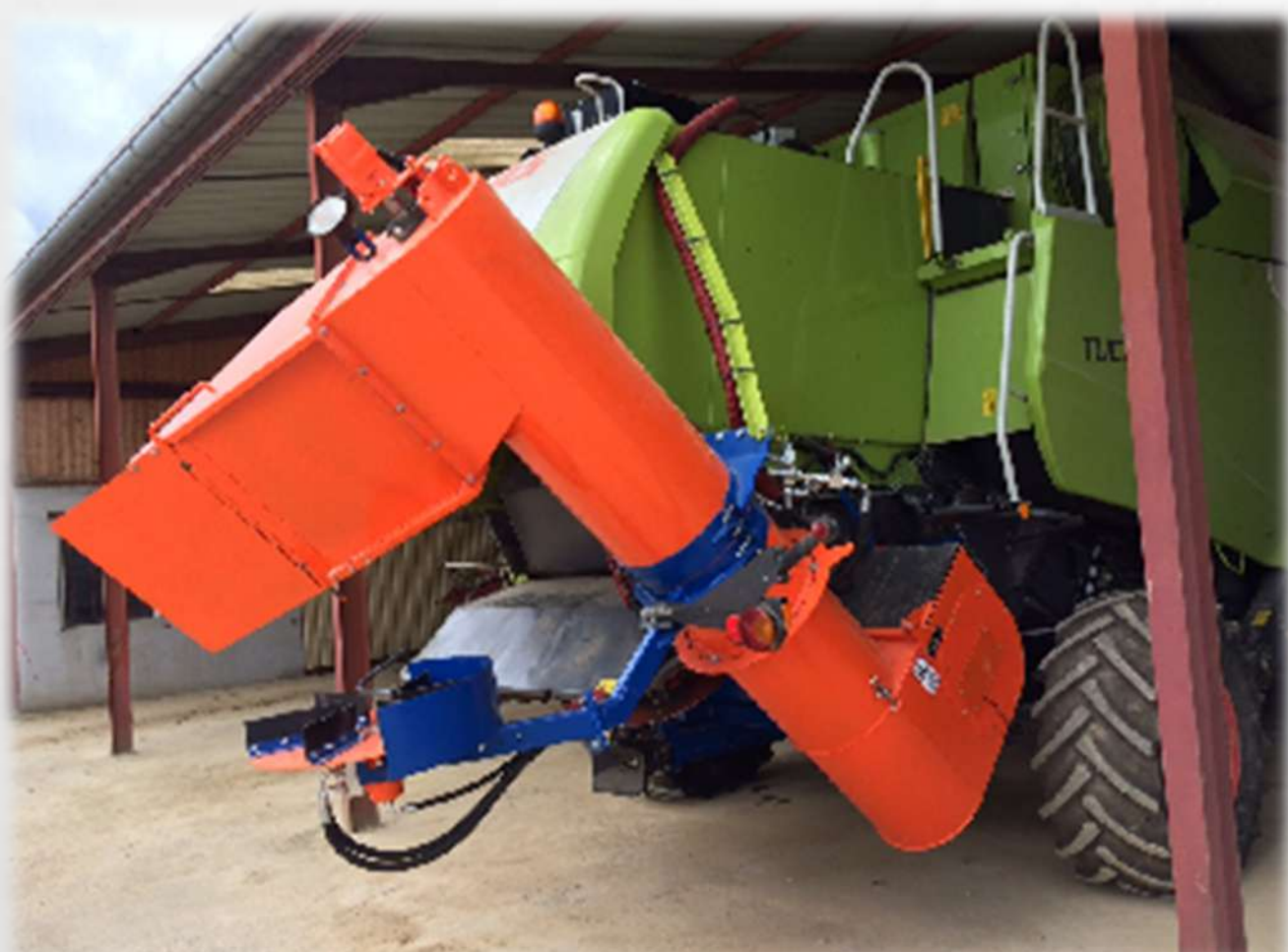
Equipement de récolte de la menue paille (sur l'andain) GAEC De Le Foultière
