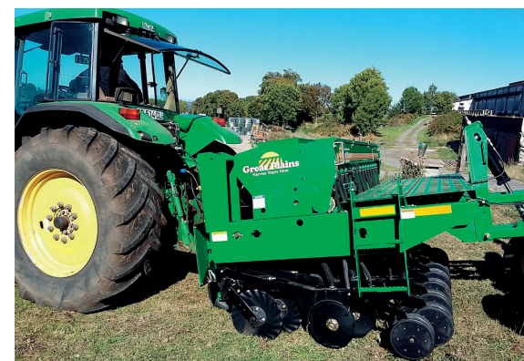
Un semoir avec double trémie permet de semer en un seul passage
